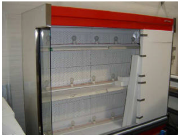
Figur 2.4. Reol. Placering af elektrisk belastning. Delvis isoleret.
