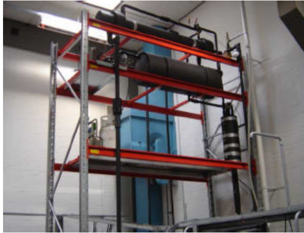
Figur 2.2. CO 2 -kondensator, receiver og niveaumåler.
