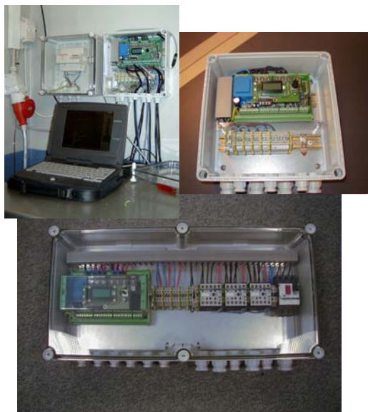
Figur 8: Eksempel på controller fra Lodam Elektronik til behovsstyret køleanlæg.
