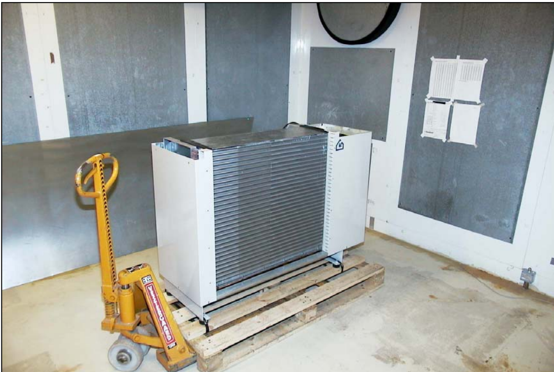
Billede af LV2005 – Varmepumpe under klargøring til prøvning på Teknologisk Institut
