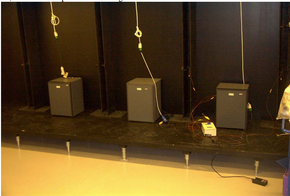
3 minibarer fra Indel B opstillet i klimakammer på Teknologisk Institut. Der blev foretaget akkrediterede energitest efter EN153
