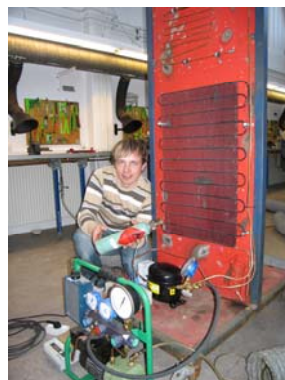
Billederne ovenfor er fra et kursus på Den jydsk Haandværkerskole, hvor norske kølemontører uddannede sig i at foretage service med brændbare kølemidler.
